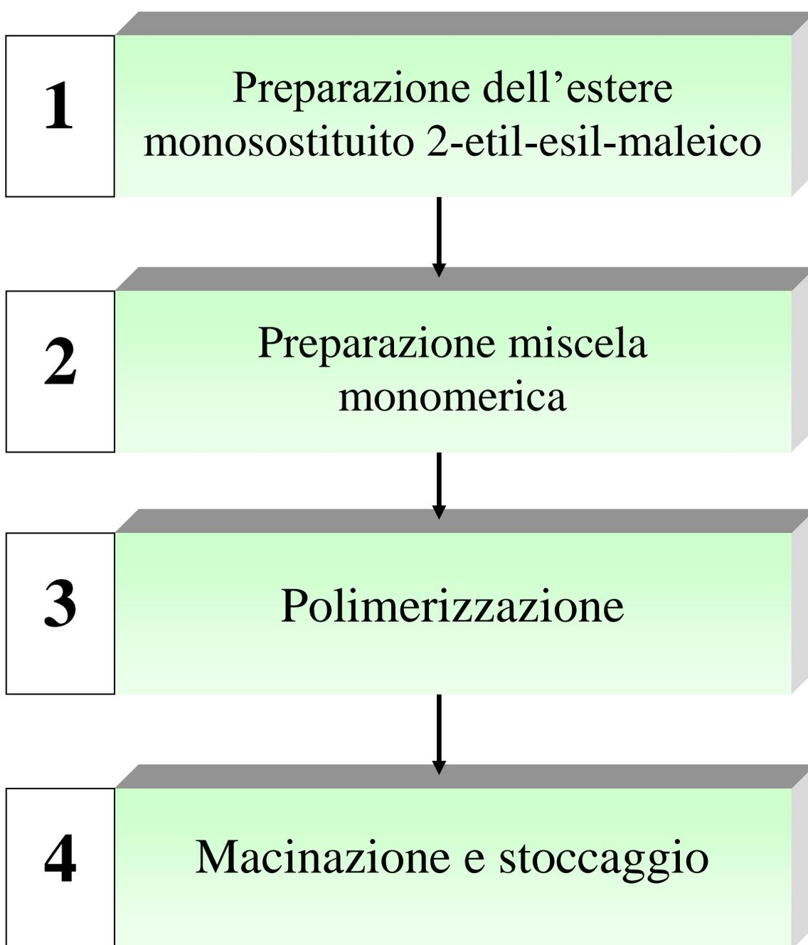
**Scheda 12.1.A****Impianto CV8 : sintesi delle fasi del processo produttivo*****Fase 1.***
